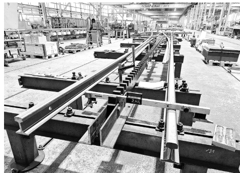
Made in Giornico: Im Bereich der Zahnstangenweichen ist Tensol Rail SA weltweit führend (Bild unten rechts)
