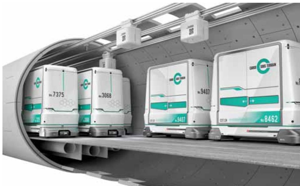
Das Prinzip von Cargo sous terrain entspricht dem eines automatischen Fördersystems. In den Tunneln verkehren rund um die Uhr selbstfahrende Transportfahrzeuge.
